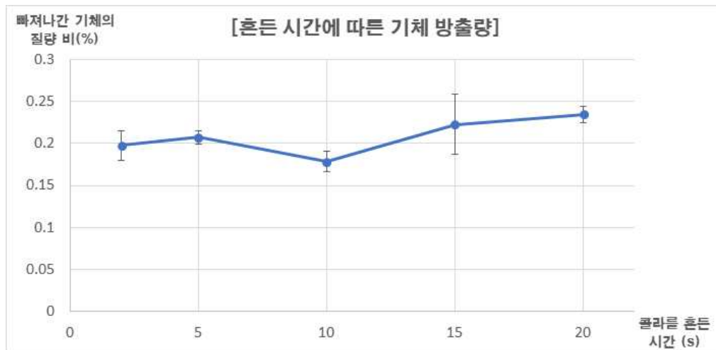
[그림 14] 콜라를 흔든 시간에 따른 기체 방출량 3회 평균 및 표준 편차
