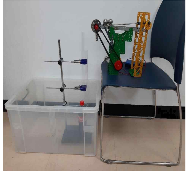
[그림 3] 콜라에 충격을 주기 위한 장치
