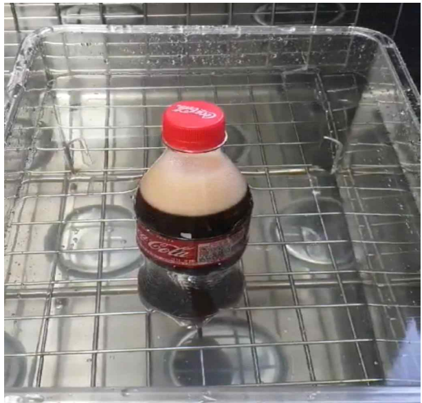
[그림 8] 초음파 세척기를 이용해 40KHz의 진동을 가했을 때
