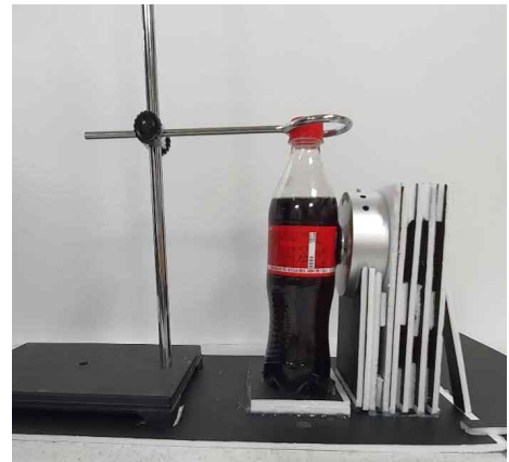
[그림 4] 콜라에 진동을 주기 위한 장치
