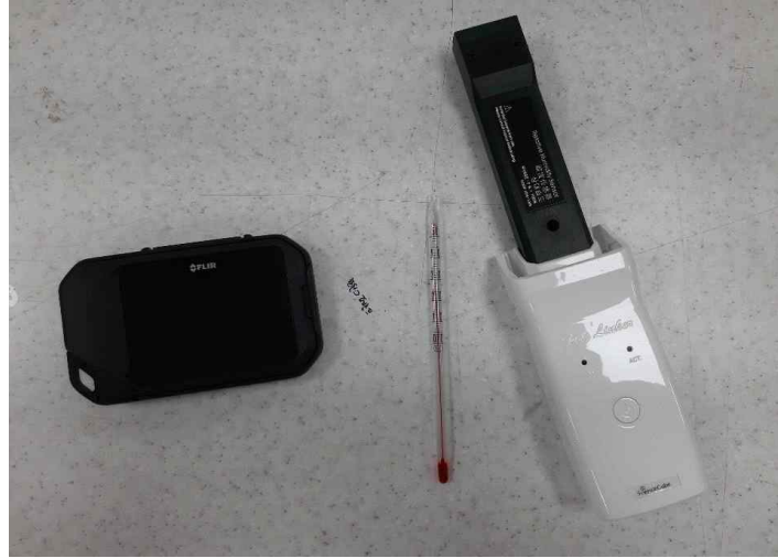
[그림 12] 열화상 카메라, 온도계, 습도 센서
