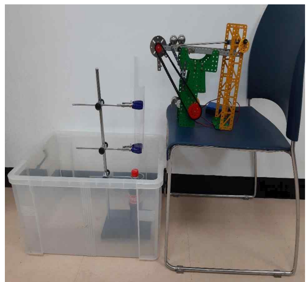
[그림 3] 콜라에 충격을 주기 위한 장치
